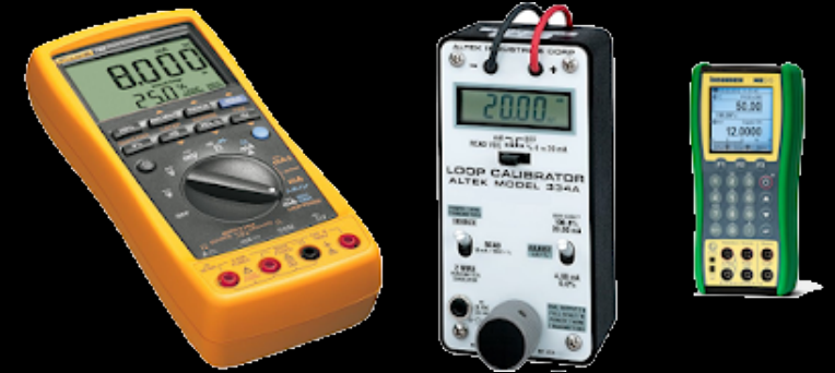
Generador y medición 4-20mA
